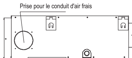
Prise pour le conduit d'air frais
